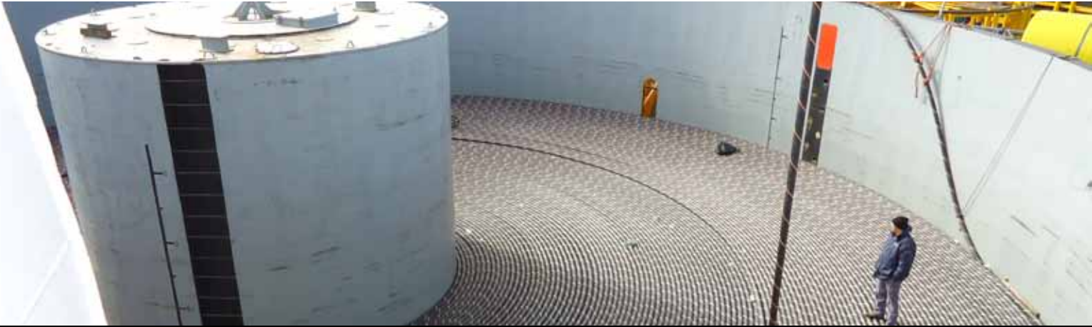
La bobina de cable del Giulio Verne, casi agotada. Fuente: Tecnival Ingeniería.
